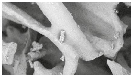
Figure 31 Lapinus MS + APP + TiO2 1100 °C (2012 °F)
