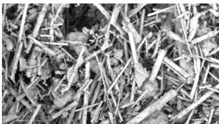
Figure 26 Lapinus CF + APP + TiO2 600 °C (1112 °F)
