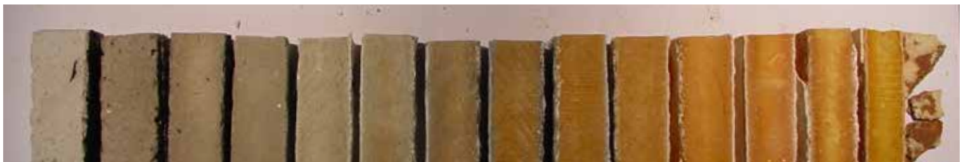
Figure 26 Lapinus CF + APP + TiO2 600 °C (1112 °F)
