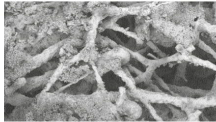
Figure 21 Lapinus CF + TiO2 850 °C (1562 °F)
